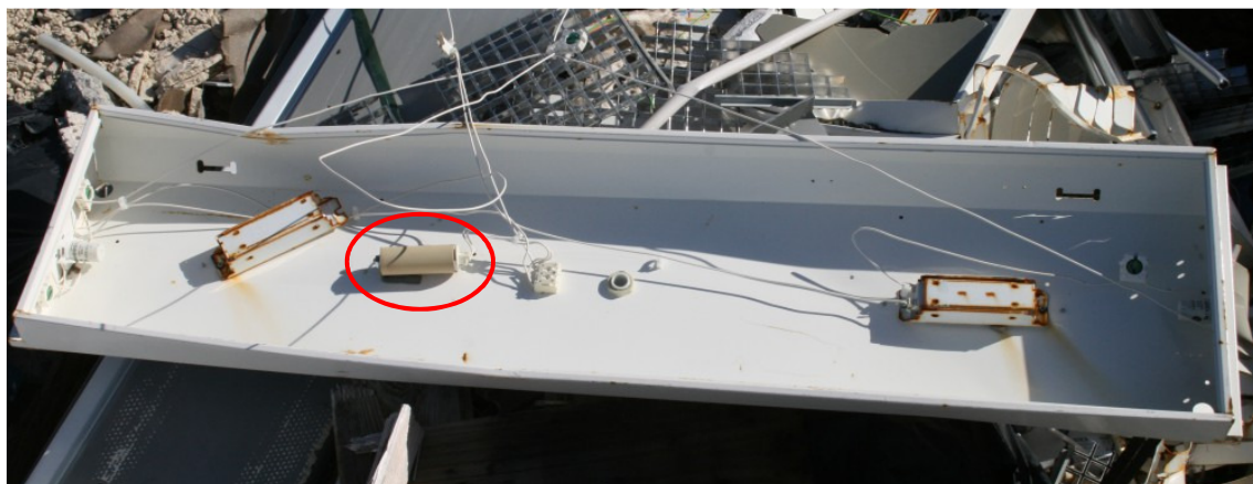
Lysstofarmatur med kondensator (rød cirkel) på Jerndumpen i Nuuk.
