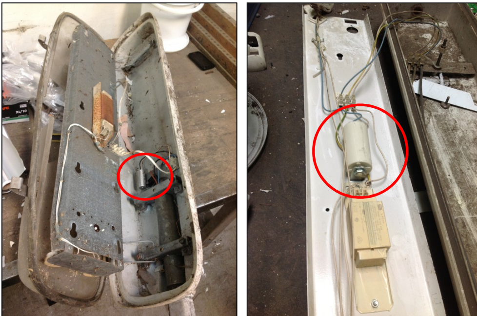
Eksempler på placering af kondensatorerne i lysstofarmaturer (rød cirkel). (foto fra [4])
